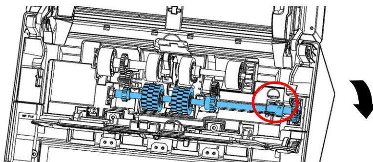
5. Снимите правый конец нижней ролика автоподатчика из гнезда и снимите ролика автоподатчика.
