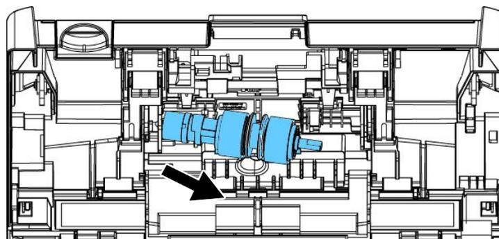
5. Снимите ролики с вала.
