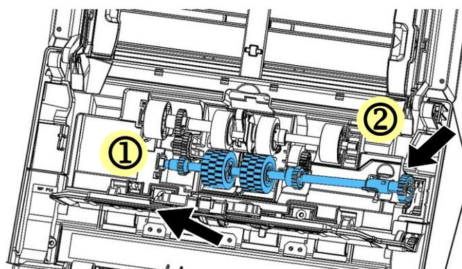
2. Передвиньте язычок на нижнем АДФ ролик, как указано на рисунке.
