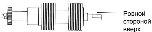
3. Вставьте левый край реверсивного ролика в отверстие, в котором он находился изначально.
