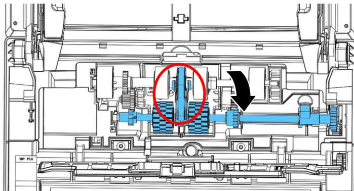
4. Закройте крышку роликов АД. Если установка выполнена правильно, вы услышите звук защелкивания.
