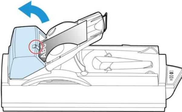
2. Pressione ambos os lados do módulo da placa de pressão ADF para dentro com seus dedos para puxar para fora o módulo da placa de pressão ADF do slot.
