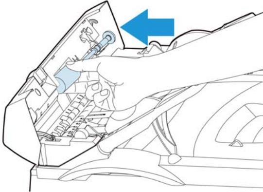
2. Insira a extremidade esquerda do rolamento ADF no buraco esquerdo do slot. Assegure-se de que a extremidade esquerda do rolamento ADF esteja inserida e descoberta como mostrado abaixo.
