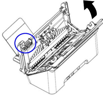
3. Consulte la siguiente sección 7.4 Reemplazar el rodillo de fricción para obtener información sobre cómo quitar el rodillo fricción.
