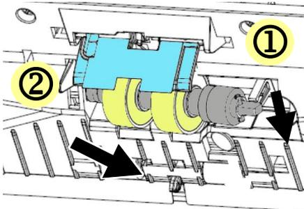
5. Retire los rodillos del eje.
