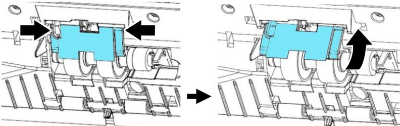
4. Presione el extremo derecho del rodillo de fricción hacia fuera para extraerlo de la ranura y extraiga a continuación el extremo izquierdo de su orificio.
