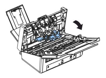
4. Pressione a extremidade direita do rolo reverso externamente para retirá-la do slot e, em seguida, destaque o lado esquerdo de seu orifício.
