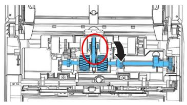
4. Feche a tampa do Rolamento ADF. Um som de encaixe poderá ser ouvido se for instalado corretamente.
