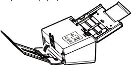
2. Deslize o ajuste da posição da bandeja de saída para colocar a bandeja de saída na posição plana.
