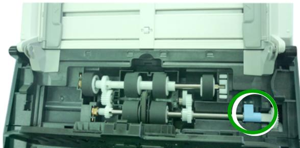
4. Cierre la carcasa del rodillo ADF. Se oirá un sonido de cierre cuando sea instalado correctamente.
