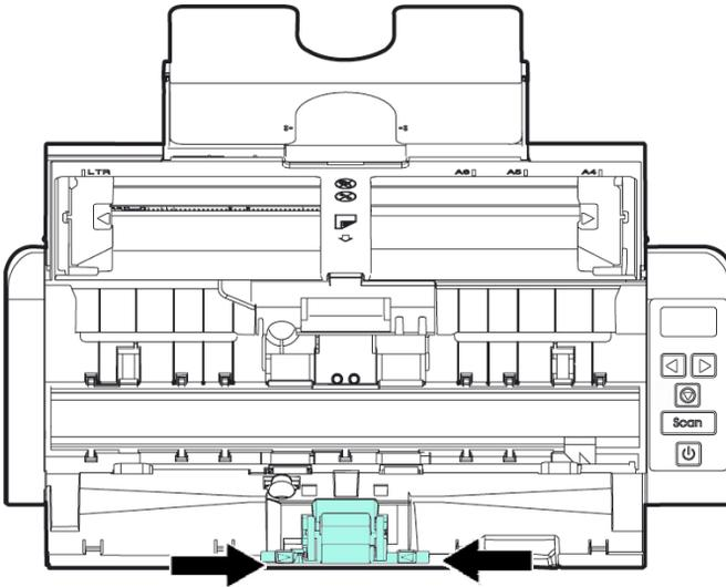
4. Sostenga los dos brazos de la almohadilla de separación con dos dedos y coloque la nueva almohadilla de separación en el escáner.
