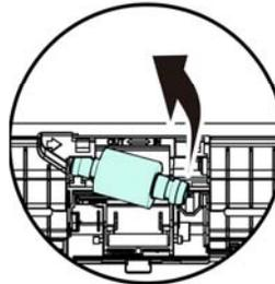
6. Acople los nuevos rodillos de inserción. Inserte el lado izquierdo del eje en la muesca y deslice el rodillo de inserción hacia la derecha. Podría escuchar un chasquido.
