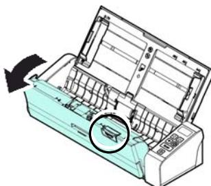
3. Вдавите пальцами обе (①) лапки отделяющей подкладки, затем поднимите и извлеките (②) отделяющую подкладку.
