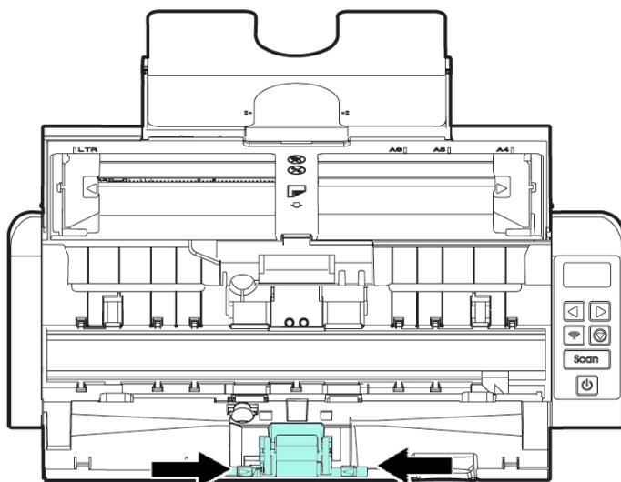
4. Вдавите пальцами две лапки новой отделяющей подкладки, и установите ее в сканер.
