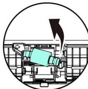
6. Прикрепите новые подающие ролики. Вставьте левый конец стержня в углубление и сдвиньте подающий ролик вправо. При правильном выполнении вы услышите щелчок.
