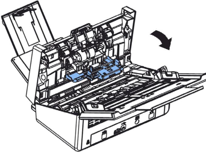
4. Presione el extremo derecho del rodillo inverso internamente para desmontarlo de la ranura y, a continuación, monte el extremo izquierdo desde su orificio.
