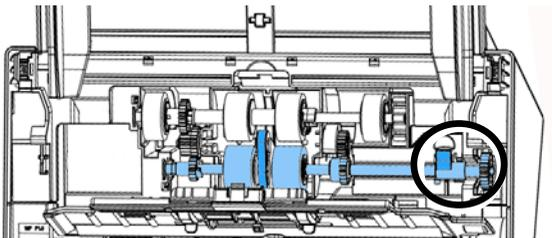
3. Cierre la carcasa del rodillo ADF. Se oirá un sonido de cierre cuando sea instalado correctamente.
