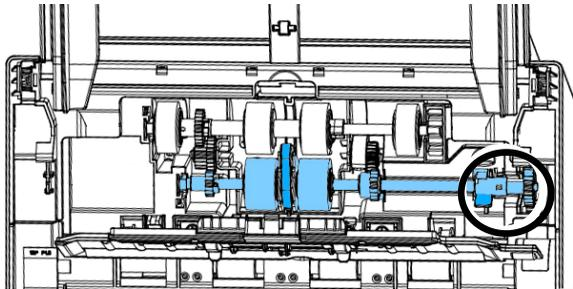
4. Separe a extremidade direita do rolamento ADF do entalhe e remova o Rolamento ADF inferior.
