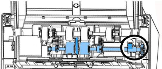
3. Feche a tampa do Rolamento ADF. Um som de encaixe poderá ser ouvido se for instalado corretamente.
