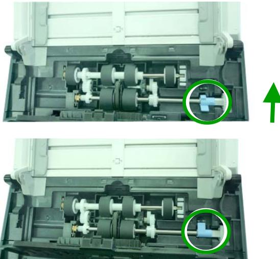
3. Cierre la carcasa del rodillo ADF. Se oirá un sonido de cierre cuando sea instalado correctamente.
