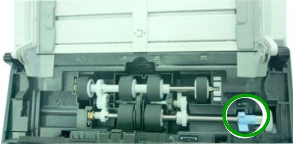
4. Separe el extremo derecho del rodillo ADF de la ranura y extraiga el rodillo ADF superior.
