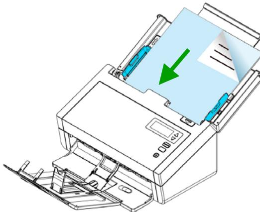
5. Richten Sie die Vorlage an den Führungsschienen aus.
