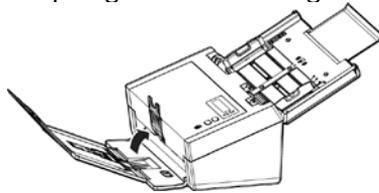
2. Schieben Sie den Positionseinsteller des Ausgabefachs so, dass sich das Ausgabefach in einer flachen Position befindet.
