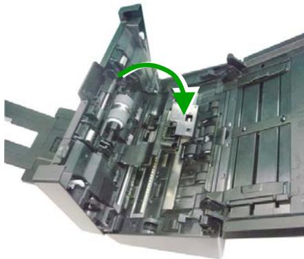
4. Drücken Sie das rechte Ende der Umkehrwalze zum Entfernen aus dem Schlitz nach außen, lösen Sie dann das linke Ende aus seiner Öffnung.
