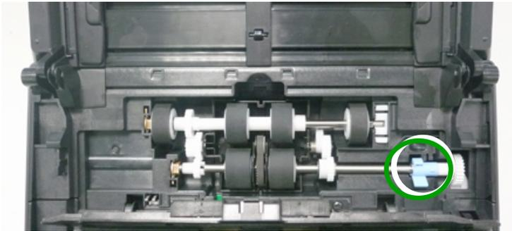
4. Lösen Sie das rechte Ende der ADF Rolle aus dem Schlitz und entfernen Sie die obere ADF-Rolle.
