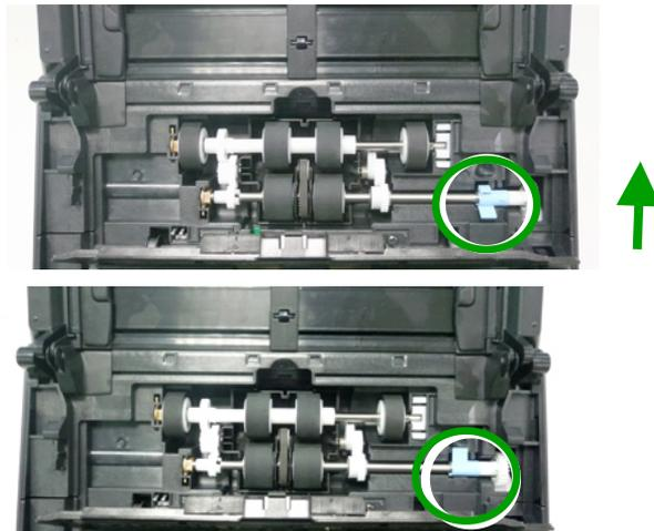
3. Cierre la carcasa del rodillo ADF. Se oirá un sonido de cierre cuando sea instalado correctamente.
