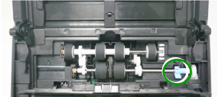
4. Separe el extremo derecho del rodillo ADF de la ranura y extraiga el rodillo ADF superior.
