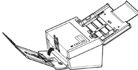
2. Deslice el regulador de posición de la bandeja de salida para colocar esta en una posición plana.
