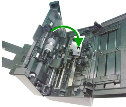
4. Presione el extremo derecho del rodillo inverso internamente para desmontarlo de la ranura y, a continuación, monte el extremo izquierdo desde su orificio.
