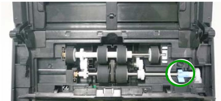
4. Separe a extremidade direita do rolamento ADF do entalhe e remova o Rolamento ADF inferior.
