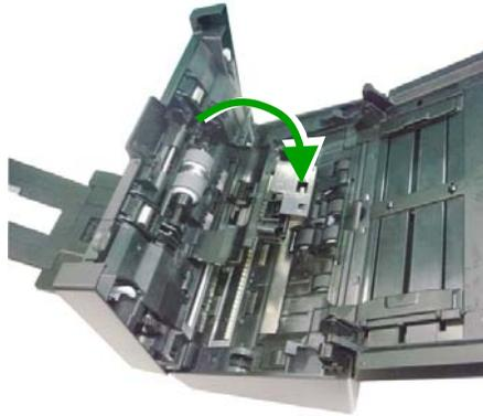
4. Pressione a extremidade direita do rolo reverso externamente para retirá-la do slot e, em seguida, destaque o lado esquerdo de seu orifício.
