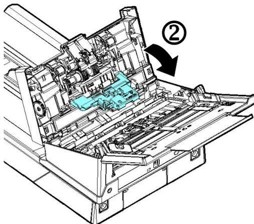
4. Нажмите на правый край реверсивного ролика по направлению вовнутрь, извлеките его из слота, а затем извлеките левый край из соответствующего отверстия.
