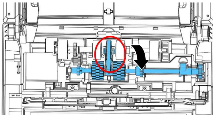
4. Закройте крышку роликов АПД. Если установка выполнена правильно, вы услышите звук защелкивания.
