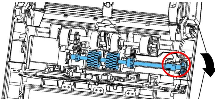
5. Снимите правый конец нижней ролика автоподатчика из гнезда и снимите ролика автоподатчика.
