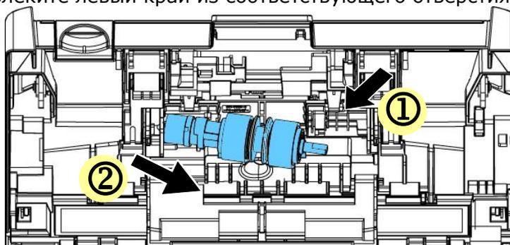
5. Снимите ролики с вала.
