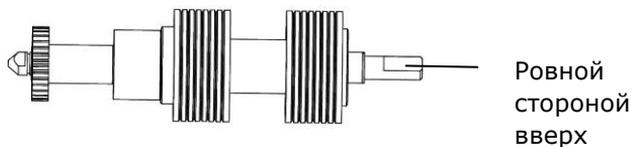
3. Вставьте левый край реверсивного ролика в отверстие, в котором он находился изначально.
