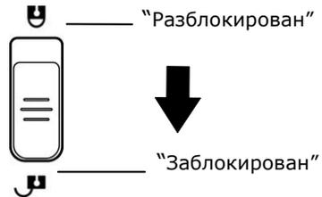
Примечание: Если сканирующий блок не находится в передней части сканера, перед транспортировкой сканера обязательно выполните следующие действия:
