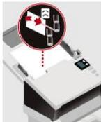
An illustration of a paper tray from a printer. A paper is partially inserted. A red circular icon with a white paper and a red 'X' is overlaid on the paper, indicating a paper jam or loading error. A red dotted line points from the icon to the paper. | <p>Ошибка захвата бумаги</p> | <ol style="list-style-type: none"><li>1. Разгладьте документы.</li><li>2. Загрузите документы так, чтобы их края слегка касались направляющих для бумаги.</li></ol> |
