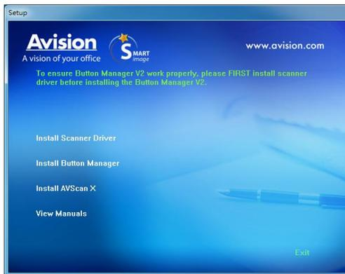
3. Нажмите на кнопку **Установки драйвера сканера**, чтобы установить драйвер сканера, а затем на кнопку **Установки Button Manager V2** для установки Button Manager V2 на компьютере.
