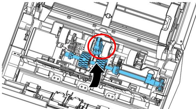
4. Передвиньте язычок на нижнем ADF ролик, как указано на рисунке.
