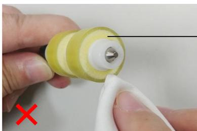
No permita que el paño humedecido con alcohol toque la espuma debajo de la superficie del rodillo ni deje que el exceso de alcohol fluya hacia la espuma.
