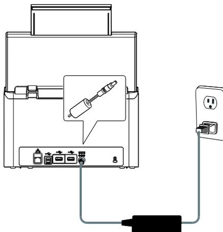
2. Conecte el otro extremo a una toma de corriente eléctrica apropiada.
