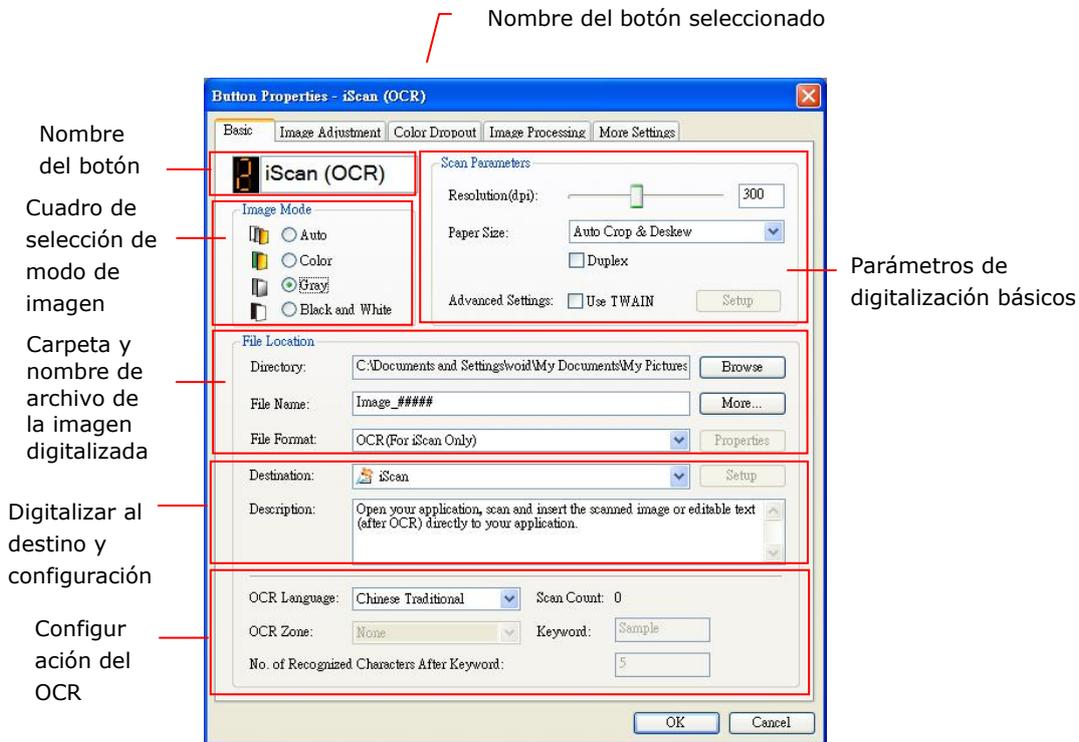
Si desea cambiar la configuración, use esta ventana para restablecer la configuración del formato de archivo, la aplicación de destino u otra configuración de digitalización.
