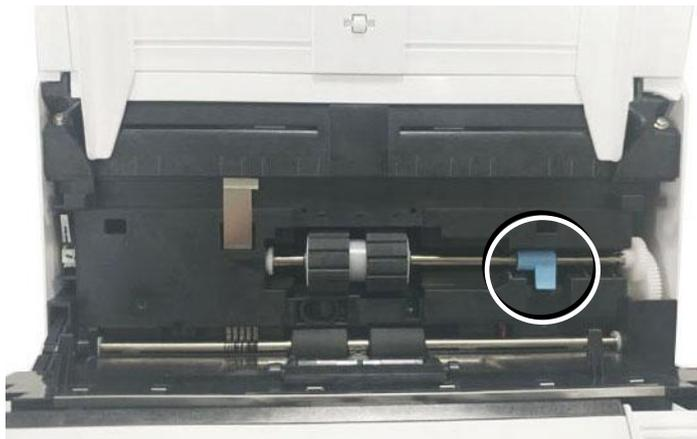
3. Cierre la carcasa del rodillo ADF. Se oirá un sonido de cierre cuando sea instalado correctamente.
