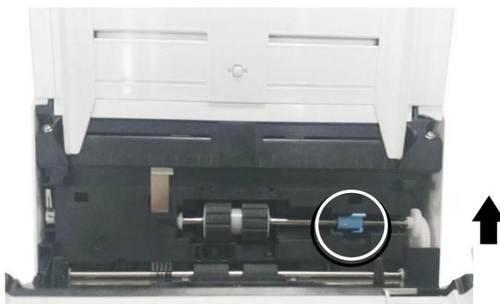
4. Separe el extremo derecho del rodillo ADF de la ranura y extraiga el rodillo ADF superior.
