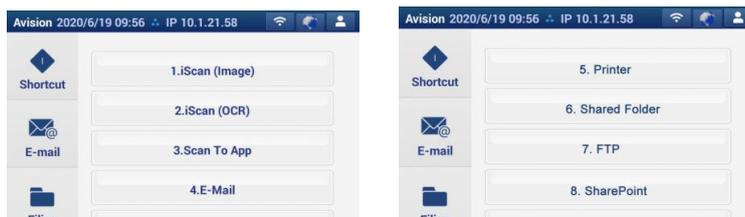
5. Compruebe el número de botón (función en la pantalla LCD para asegurarse que ha seleccionado la configuración de digitalización y la aplicación de destino adecuadas. Por ejemplo, si desea digitalizar con el botón (función) 3 "Scan to App"(Digitalizar a aplicación), que abre Microsoft Paint y muestra la imagen digitalizada en la ventana de Microsoft Paint, la pantalla LCD debe mostrar "Function 3" (Función 3).
