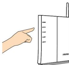
3. En la pantalla Home (Inicio) del panel táctil LCD, pulse **[Settings]** (**Configuración**)>**[Network]** (**Red**). Asegúrese de que la opción **[Wireless Client]** (**Ciente inalámbrico**) está activada. En la página inalámbrica, pulse el botón **[More Settings]** (**Más configuraciones**) y, a continuación, elija **[WPS Push Button]**.
