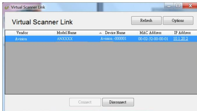
2. Elija el escáner que desee conectar y, a continuación, presione [**Conectar**]. Si la conexión se realiza correctamente, se mostrará una marca de conexión.
