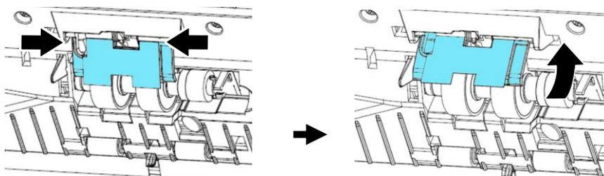
4. Presione el extremo derecho del rodillo de fricción hacia fuera para extraerlo de la ranura y extraiga a continuación el extremo izquierdo de su orificio.
