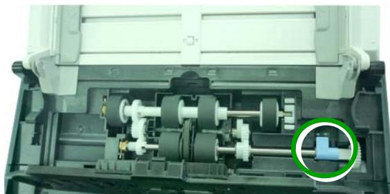
2. Закройте крышку роликов АПД. Если установка выполнена правильно, вы услышите звук защелкивания.
