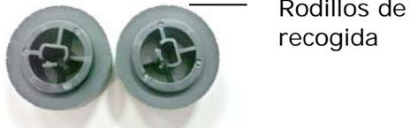
5. Alinee la dirección del centro del rodillo con el extremo del eje e instale el rodillo en el eje.
