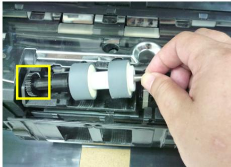
5. Inserte el realice derecho del realice rodillo inverso en su ranura. Si la operación se realice correctamente, podrá escuchar sonido de clic.
