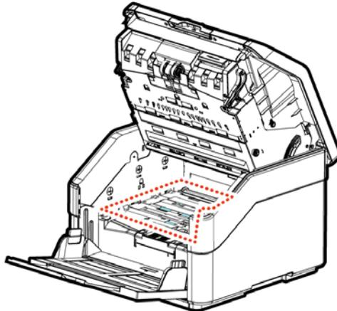
5. Cuando finalice la limpieza, presione el botón **[Digitalizar]**; el rodillo de avance girará un poco automáticamente.
