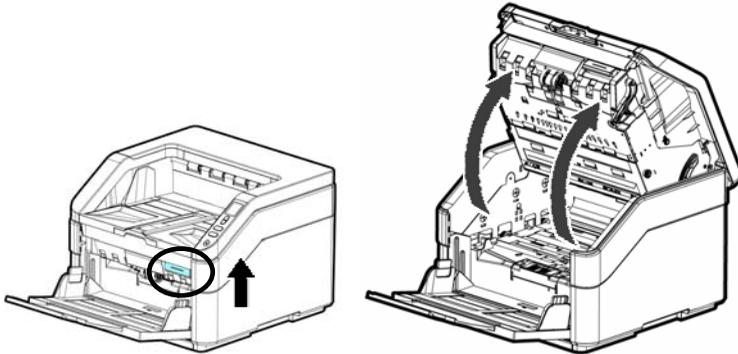
2. Tire hacia abajo de la tapa del rodillo de recogida.
