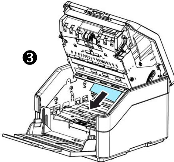
3. Cierre el ADF presionando hacia abajo en el centro de dicho ADF para devolverlo a su posición original hasta que escuche un clic.
