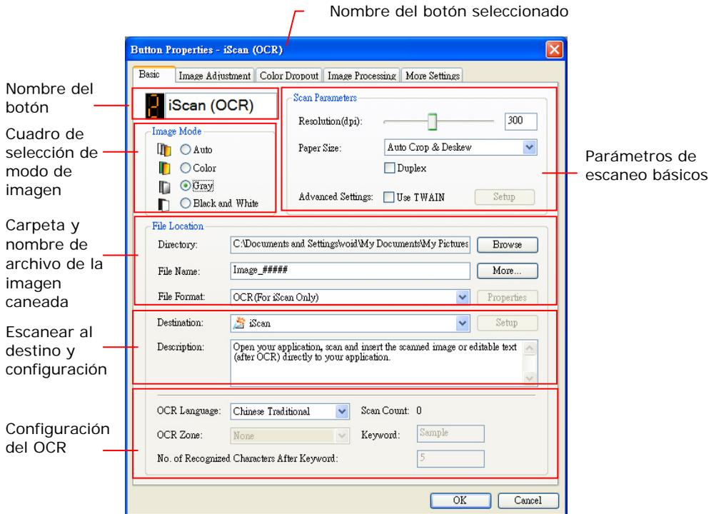
Si desea cambiar la configuración, use esta ventana para cambiar la configuración del formato de archivo, aplicación de destino u otras configuraciones de escaneo. Consulte “Configurar el botón” en la siguiente sección para restaurar la configuración.
