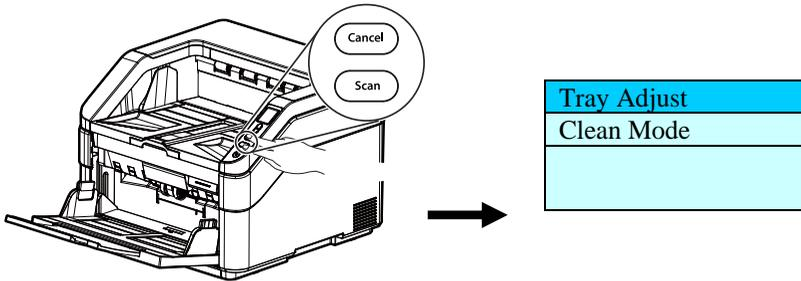
2. Use ▲ o ▼ para seleccionar [**Modo de limpieza**] y, a continuación, presione [**Digitalizar**] para confirmar la operación.
