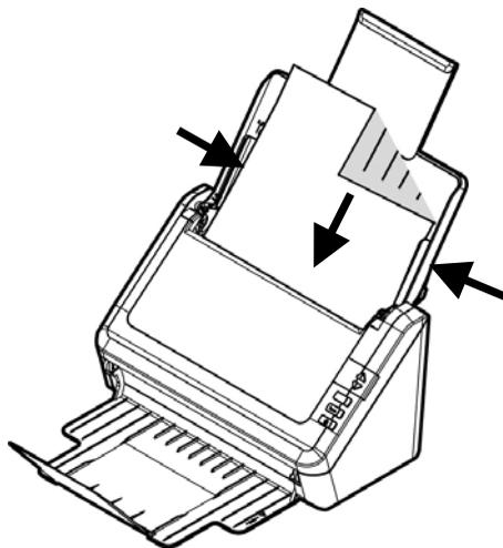
5. 请确定导纸板与输入纸张的边缘对齐。
