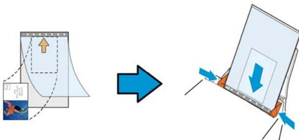
2. 将文件护套的灰色区块(印刷区块)朝下，放入扫描仪的自动输稿器中。
