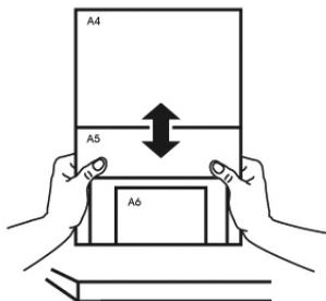
4. 请将文件置中放入自动给纸器中，并确认最大尺寸的文件的边缘轻轻碰触两边的导纸槽。
