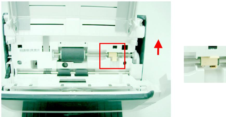
4. 将右边的滚轴从凹槽中移除，再将左边的滚轴从凹槽中移除。
