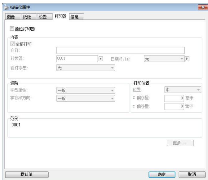
**选项：外接打印机、数位打印机。** 如果你安装了外接打印机，请选择外接打印机。 如果未安装打印机，则请选择数字打印机。 请注意，外接打印机提供垂直及背面打印功能，而数字打印机则提供水平及正面打印功能。
