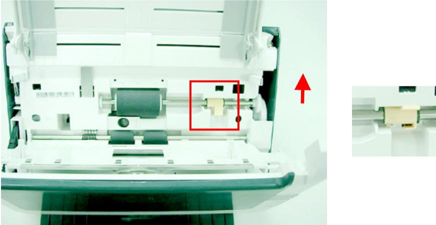
4. Quite del escáner el extremo derecho del rodillo del ADF y quite el rodillo del ADF.
