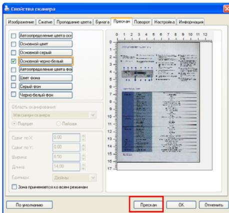
3. Щелкните на вкладке Color Dropout (Исключение цвета). Откроется окно Color Dropout (Исключение цвета) с кнопкой Preview Window (Окно просмотра).
