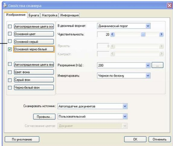
6. В окне выбора изображения выберите необходимый тип сканируемого изображения (по умолчанию установлен параметр Front B&W (Передняя сторона, черно-белое)). При использовании двустороннего сканера выберите параметры Front (Передняя сторона) и Rear (Задняя сторона), чтобы сканировать обе стороны документа.
