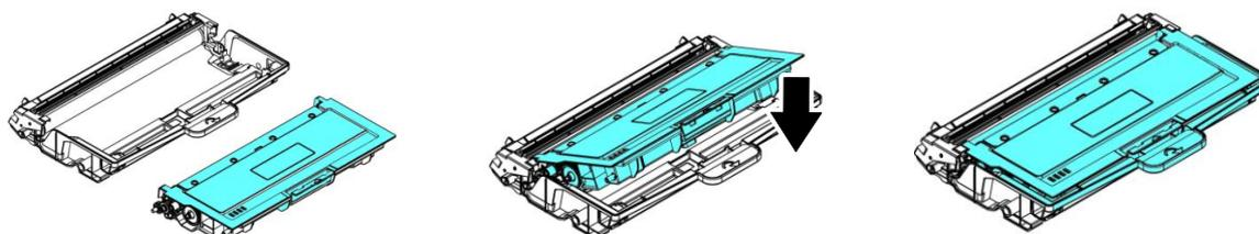
5. 將調整板往左滑動再往右滑動數次，以清潔感光鼓組件內的電暈絲。（感光鼓組件使用一段時間後，部份碳粉會殘留在電暈絲。）
