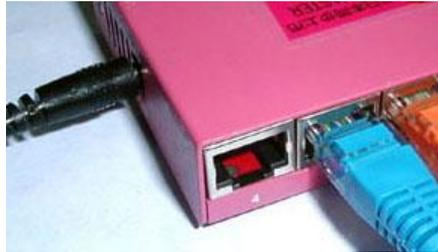
2. Verbinden Sie das andere Ende wie abgebildet mit dem
