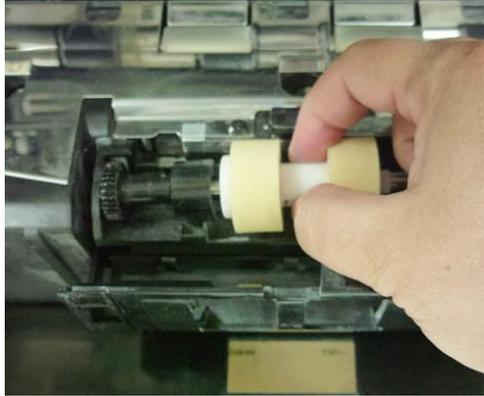
4. Entfernen Sie die Rollen von der Welle.
