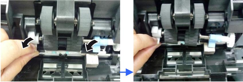
4. Entfernen Sie die Rollen von der Welle.
