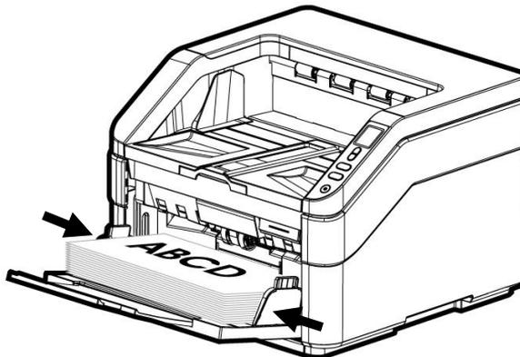
5. Richten Sie die Vorlage an den Führungsschienen aus.
