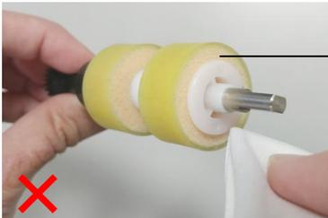
Achten Sie darauf, dass das mit Alkohol angefeuchtete Tuch nicht mit dem Schaumstoff unter der Oberfläche der Walze in Berührung kommt. Achten Sie darauf, dass nicht übermäßig viel Alkohol in den Schaumstoff gelangt.
