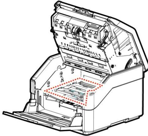
5. Bei Abschluss der Reinigung drücken Sie die [**Scan**]-Taste, die Einzugsrolle dreht sich automatisch ein wenig.
