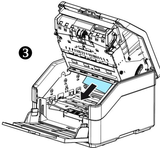
3. Schließen Sie den ADE, indem Sie die Mitte des ADE nach unten in die Ausgangsposition drücken, bis er hörbar einrastet.
