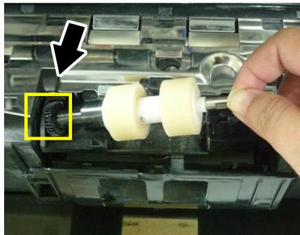
7. Stecken Sie das rechte Ende der neuen Umlenkwalze in ihren Schlitz. Wird die Walze richtig eingesetzt, hört man ein Einschnappgeräusch.
