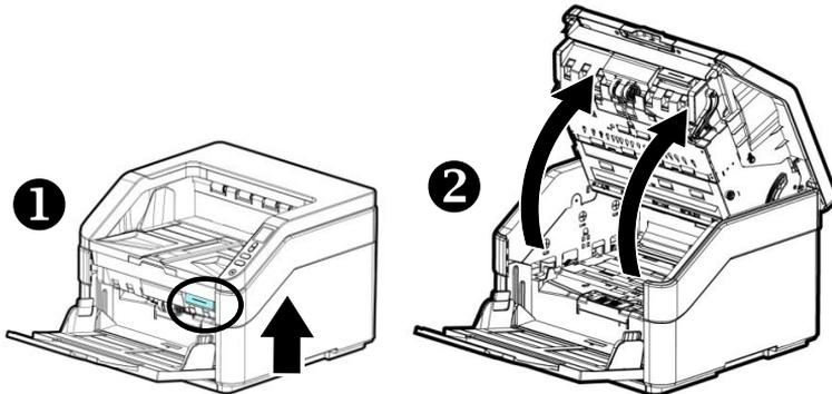
2. Öffnen Sie die Abdeckung der Umlenkwalze.
