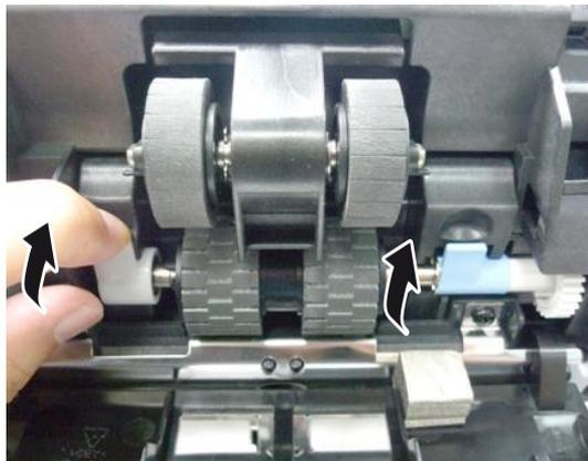
7. Klappen Sie die Abdeckung der ADF-Walze nach oben und schließen Sie sie, wie dargestellt ist.
