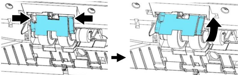
4. Drücken Sie auf das rechte Ende der Reibrolle, um sie aus dem Schlitz zu entfernen und entnehmen Sie anschließend das linke Ende aus der Öffnung.
