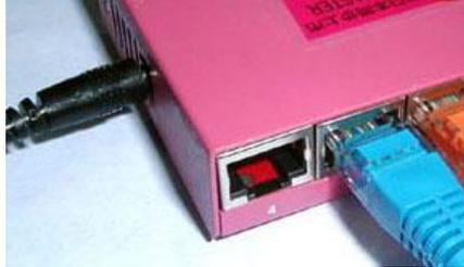
2. Verbinden Sie das andere Kabelende wie abgebildet mit dem LAN-Anschluss an der Rückseite des Produkts.
