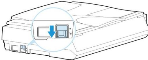
**Abbildung 2-1 Transportsicherung entfernen**
