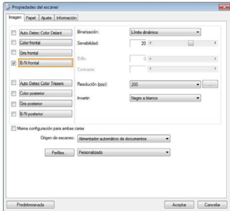
6. En el Cuadro de selección de imagen, elija el tipo de imagen que desee para la imagen escaneada. (El predeterminado es B/N frontal) Si tiene un escáner dúplex, elija Frontal y posterior para escanear ambas caras del documento.
