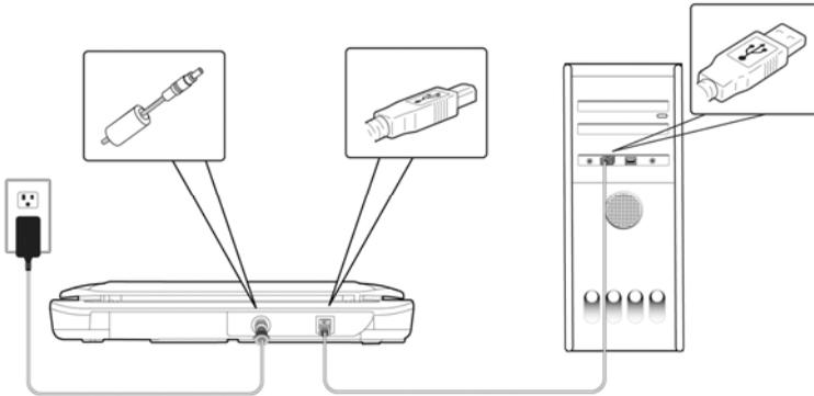
2. El ordenador debería detectar un nuevo dispositivo USB y mostrar un mensaje **"New Hardware Found"**.
