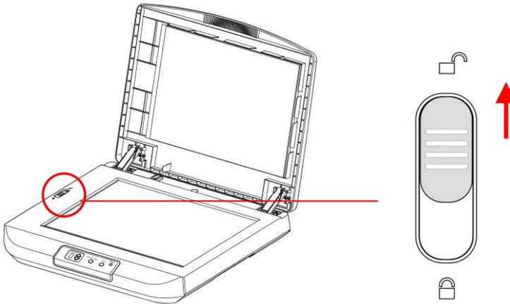
**Figura 2-1 Desbloqueando el Escaner**
