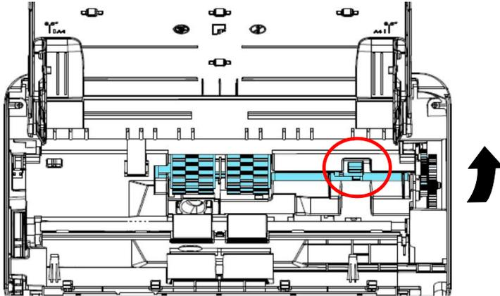
4. Retirez l'extrémité droite du galet de l'ADF du scanner et enlevez le galet de l'ADF.
