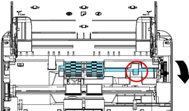
3. Fermez le couvercle du galet de l'ADF. Un claquement se fait entendre s'il est correctement installé.
