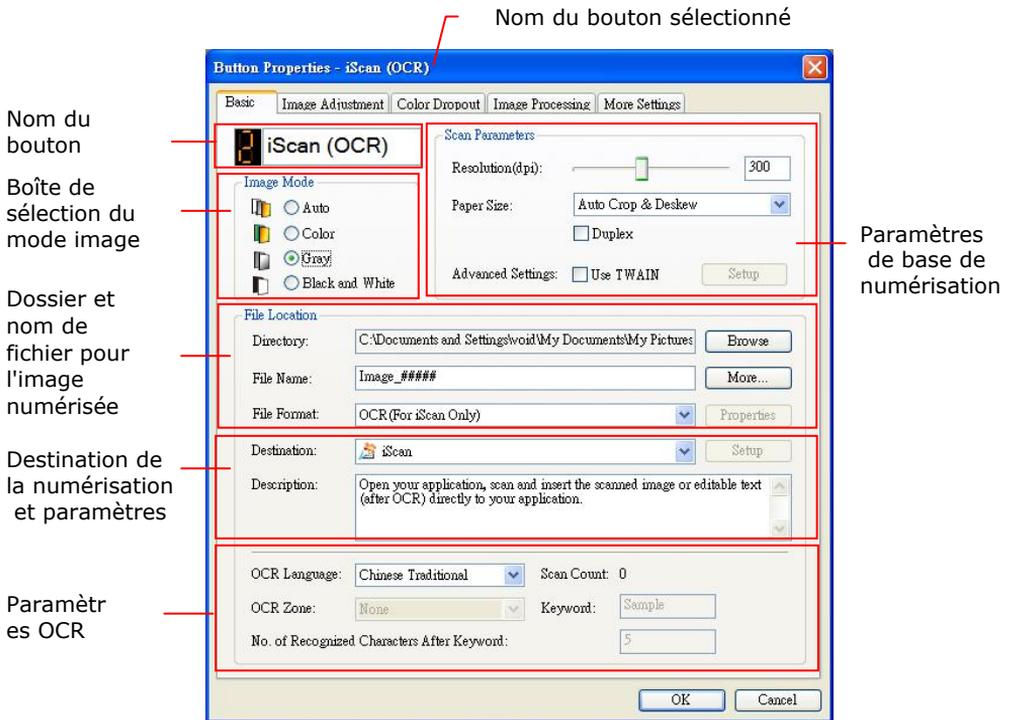
Si vous désirez changer le paramètre, utilisez cette fenêtre pour réinitialiser le paramètre pour le format du fichier, l'application de destination, ou d'autres paramètres de numérisation. Consultez "Configuration des boutons" dans la section suivante pour réinitialiser les paramètres.
