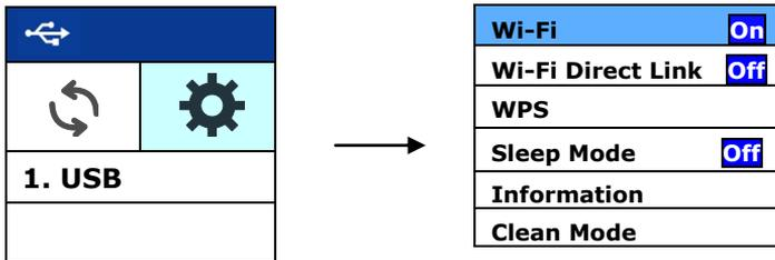
2. Assurez-vous que [Wifi  Off] est sélectionné et appuyez sur  $\blacktriangleright$  (OK) pour activer la connexion Wi-Fi.
