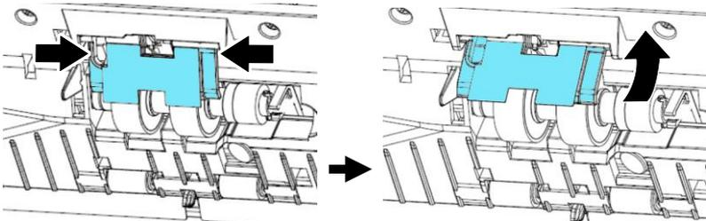
4. Appuyez sur l'extrémité droite du rouleau de friction à l'extérieur pour le détacher de la fente, puis détacher l'extrémité gauche de son trou.
