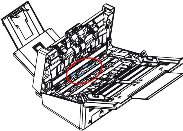
5. Una volta terminata la pulizia, premere il tasto [Scansione]
