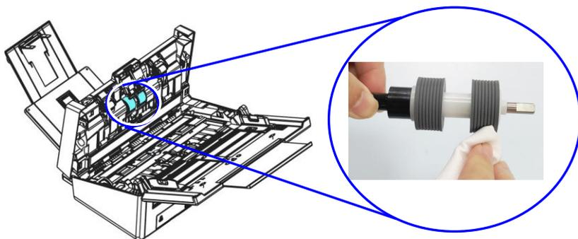
5. Fare riferimento alla sezione successiva 7.6 Sostituzione del rullo di inversione per informazioni su come installare il rullo di inversione.
