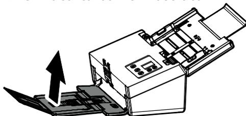
2. Far scorrere il regolatore della posizione del vassoio di uscita in modo da mettere il vassoio in posizione pari.
