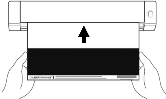
7. Clique em "OK" na caixa de diálogo "**Insert calibration sheet**" (Inserir folha de calibração) para iniciar a calibração do scanner.
