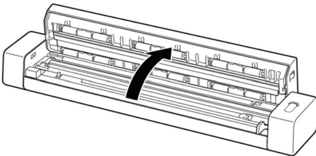
2. Delicadamente, limpe os rolos de alimentação e o vidro no scanner, e a tampa do CIS com o pano de limpeza (*incluído*).
