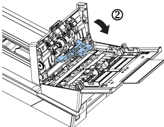
4. Pressione a extremidade direita do rolo reverso externamente para retirá-la do slot e, em seguida, destaque o lado esquerdo de seu orifício.
