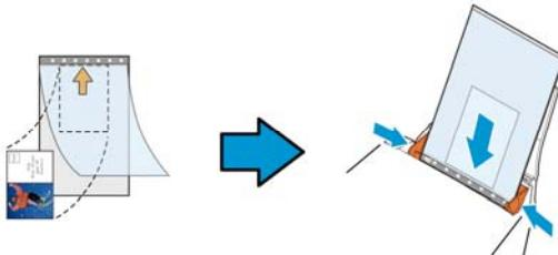
**2. Coloque a Folha de Transporte com a seção cinzenta (impressa) voltado para baixo.**
