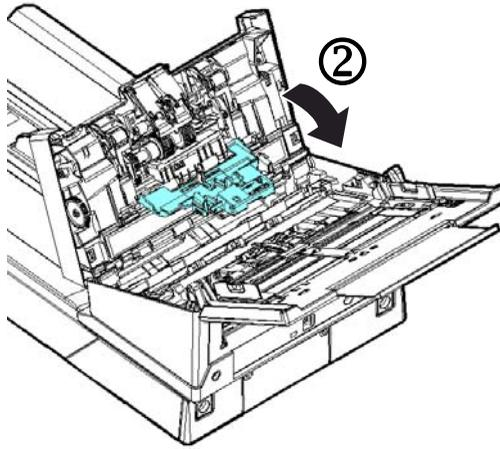
4. Pressione a extremidade direita do rolo reverso externamente para retirá-la do slot e, em seguida, destaque o lado esquerdo de seu orifício.
