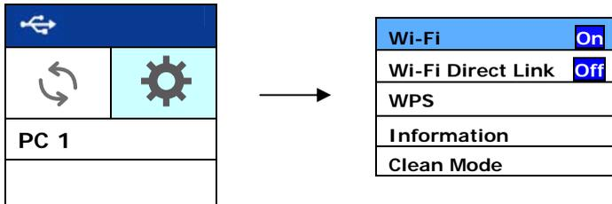
2. Verifique se [Wi-Fi Off] está selecionado e pressione  $\blacktriangleright$  (OK) para ativar a conexão Wi-Fi.
