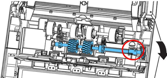
5. Separe a extremidade direita do rolamento ADF do entalhe e remova o Rolamento ADF inferior.
