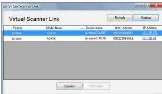
2. Clique no endereço IP do scanner, conforme indicado. A página da web do scanner será exibida.
