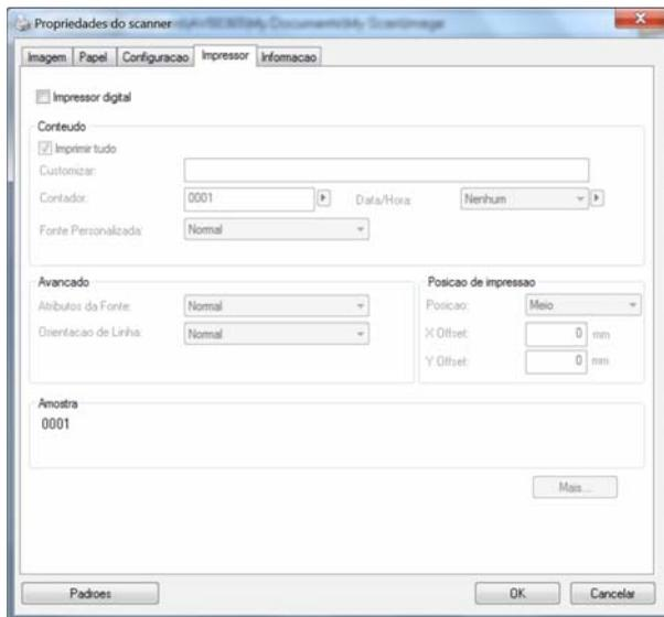
**Opção: Mecanismo de Impressão Externo, Mecanismo de Impressão Digital.** Se instalou um mecanismo de impressão externo, escolha o mesmo. Se não possui um mecanismo de impressão, escolha o mecanismo de impressão digital. Tenha em conta que o Mecanismo de Impressão Externo assegura uma capacidade de impressão vertical e no verso, ao passo que o mecanismo de impressão digital assegura uma capacidade de impressão horizontal e na parte frontal.
