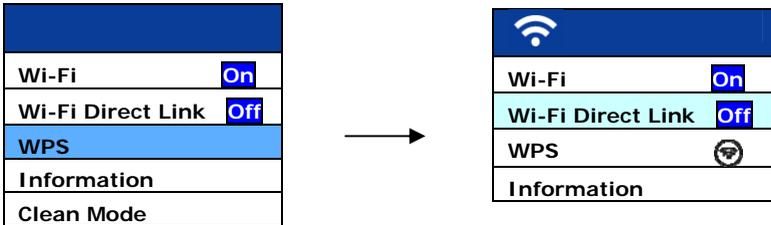
4. Para verificar se a conexão WPS foi bem-sucedida, verifique o ponto de acesso conectado selecionando [Info]> [Wi-Fi]. O SSID (nome da rede) conectado e o endereço do Mac serão exibidos.
