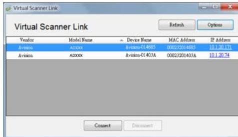
2. Escolha o scanner a que você deseja se conectar e, em seguida, pressione [**Conectar**]. Se a conexão for bem sucedida, uma marca de conexão será exibida como mostrado.
