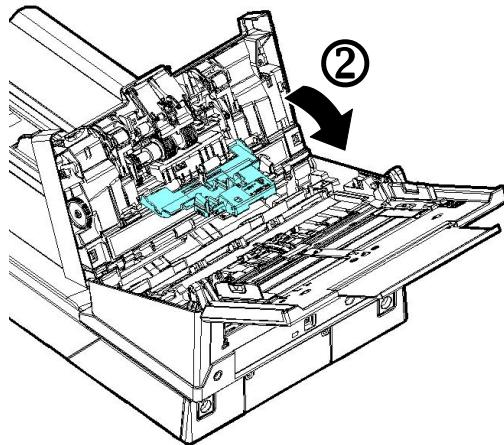
4. Нажмите на правый край реверсивного ролика по направлению вовнутрь, извлеките его из слота, а затем извлеките левый край из соответствующего отверстия.
