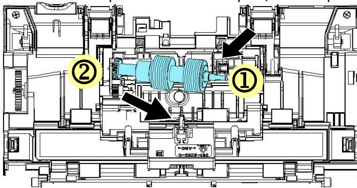
5. Снимите ролики с вала.
