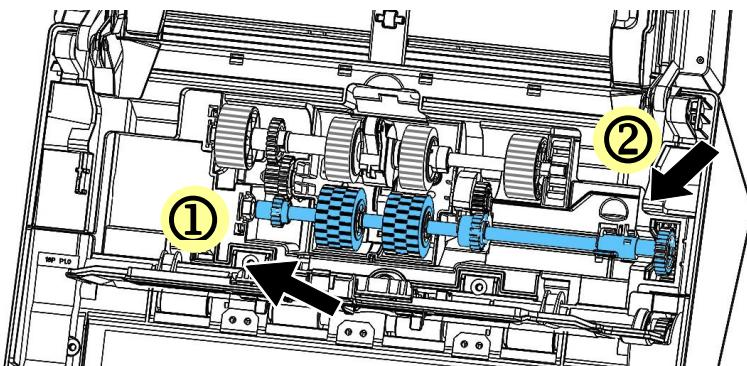
2. Передвиньте язычок на нижнем ADF ролик, как указано на рисунке.
