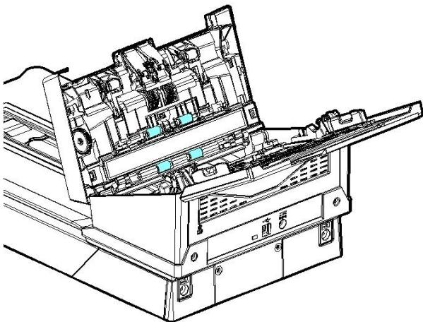
5. Завершив очистку, нажмите на кнопку [**Сканировать**] ▶ . Будет выполнено автоматическое вращение подающего ролика.
