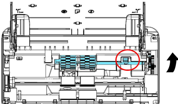
4. Высвободите правый конец ролика ADF из корпуса сканера и извлеките ролик.
