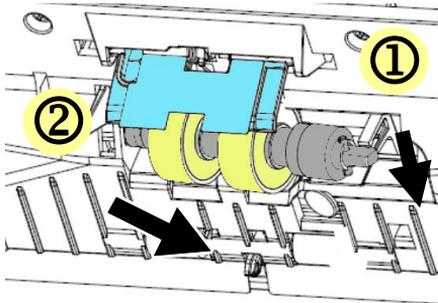
5. Снимите ролики с вала.
