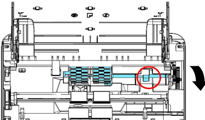
3. Закройте крышку ролика ADF. При правильной установке вы должны услышать щелчок.
