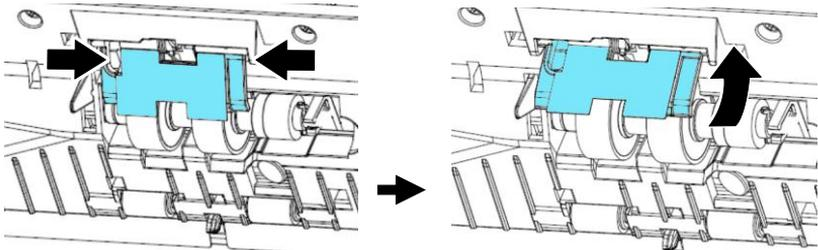
4. Протолкните правый конец фрикционного ролика наружу, чтобы вынуть его из паза, а затем выньте его левый конец из установочного отверстия.
