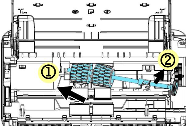
2. Передвиньте лапку ролика ADF **ВНИЗ**.
