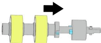
2. Вставьте левый конец фрикционного ролика в его установочное отверстие.
