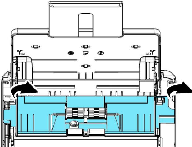
3. Передвиньте лапку ролика ADF **ВВЕРХ**, как показано на рисунке.
