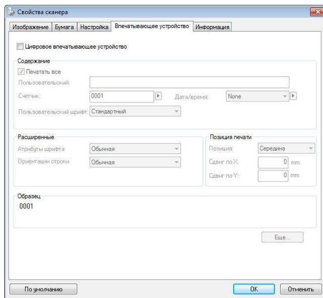
**Выбор: External Imprinter, Digital Imprinter (Внешний принтер, Цифровой штамп).** Если у вас установлено внешнее устройство печати, выбирайте External Imprinter (Внешний принтер). Если внешнее устройство печати отсутствует, выбирайте Digital Imprinter (Цифровой штамп). Примечание: Параметр External Imprinter (Внешний принтер) позволяет печатать вертикально и на обратной стороне документа, а Digital Imprinter (Цифровой штамп) наносится только горизонтально на переднюю сторону документа.
