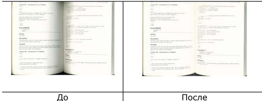
**Background Processing (Фоновая обработка):** Параметр [**Background Processing (Фоновая обработка)**] позволяет сглаживать фоновый цвет или удалять его для повышения четкости изображения. Данный параметр особенно полезен для сканирования документов на цветных бланках, таких как счета-фактуры.
