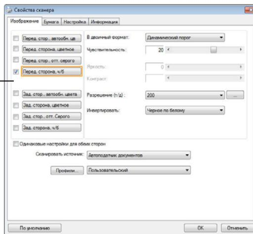
6. В окне выбора изображения выберите необходимый тип сканируемого изображения (по умолчанию установлен параметр Front V&W (Передняя сторона, черно-белое)). При использовании двустороннего сканера выберите параметры Front (Передняя сторона) и Rear (Задняя сторона), чтобы сканировать обе стороны документа.
