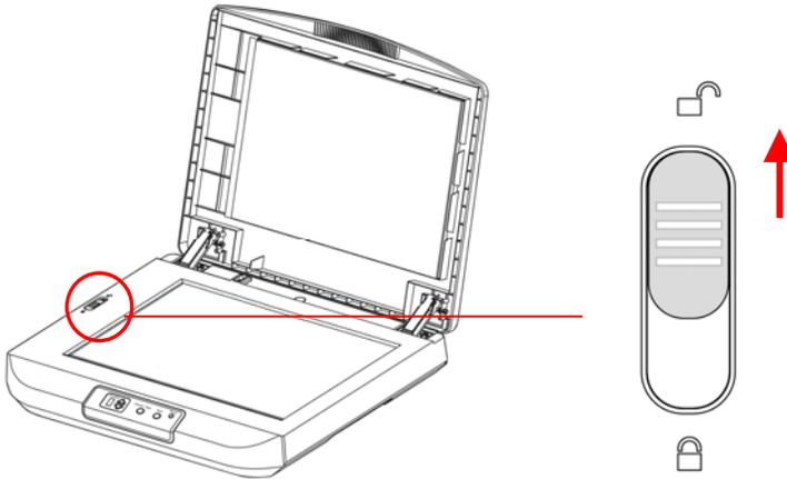
Abbildung 2-1 Transportsicherung entfernen
