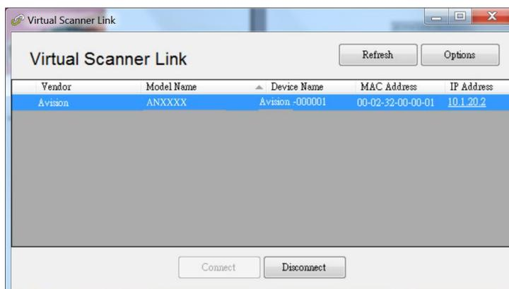
2. Selezionare lo scanner da connettere e quindi premere [**Connetti**]. Se la connessione viene eseguita correttamente, verrà visualizzato il simbolo della connessione come indicato.
