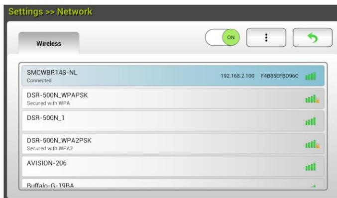
5. Selezionare un punto d'accesso e fare clic su **[Connect (Connetti)]** per collegare lo scanner a un punto d'accesso specifico, SMCWBR14S-NL, ad esempio. In pochi secondi, se la connessione è riuscita, saranno visualizzati l'indirizzo IP e l'indirizzo MAC dello scanner, come indicato sopra.
