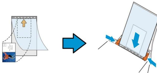
2. Caricare il foglio di supporto con la sezione grigia (sezione stampata) rivolta verso il basso.
