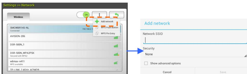
2. Inserire il nome SSID rete e selezionare Security Mode (Modalità di protezione), Encryption Type (Tipo di crittografia) e Network Key (Chiave di rete), quindi toccare **[Save (Salva)]** per cercare manualmente la rete wireless.
