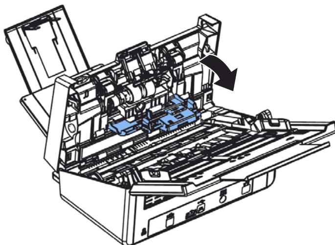
4. Нажмите на правый край реверсивного ролика по направлению вовнутрь, извлеките его из слота, а затем извлеките левый край из соответствующего отверстия.
