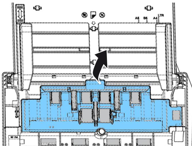
3. Передвиньте язычок на нижнем ADF ролик, как указано на рисунке.
