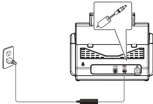
2. Вилку кабеля питания подключите к соответствующей электрической розетке.
