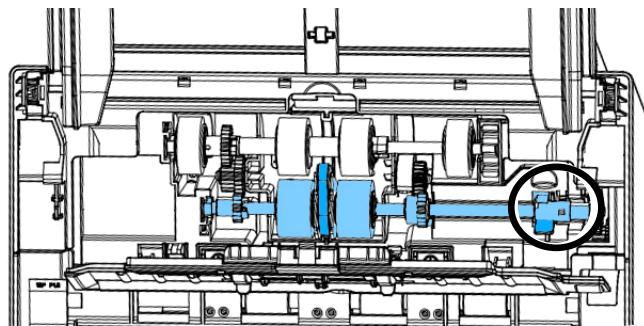
4. Снимите правый конец нижней ролика автоподатчика из гнезда и снимите ролика автоподатчика.
