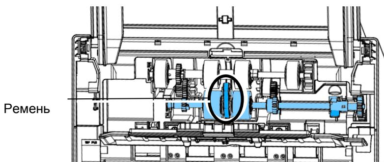
2. Закройте крышку роликов АПД. Если установка выполнена правильно, вы услышите звук защелкивания.
