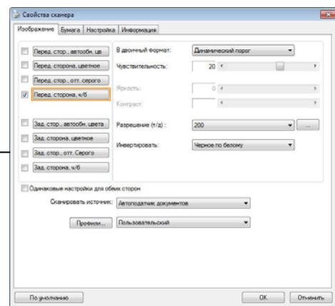
6. В окне выбора изображения выберите необходимый тип сканируемого изображения (по умолчанию установлен параметр Front B&W (Передняя сторона, черно-белое)). При использовании двустороннего сканера выберите параметры Front (Передняя сторона) и Rear (Задняя сторона), чтобы сканировать обе стороны документа.
