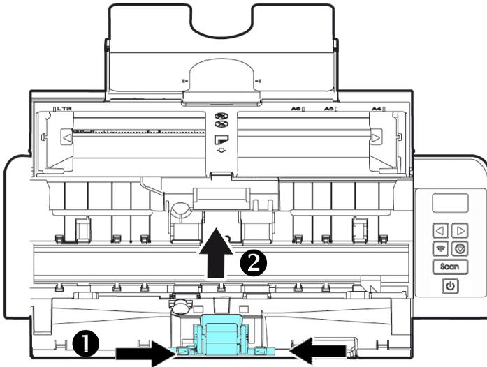
4. Segure os dois braços do suporte de separação com dois dedos e conecte o novo suporte de separação no scanner.
