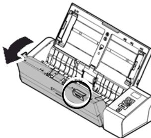
3. Limpe o suporte de separação, os rolos e o vidro com o pano de limpeza incluído.
