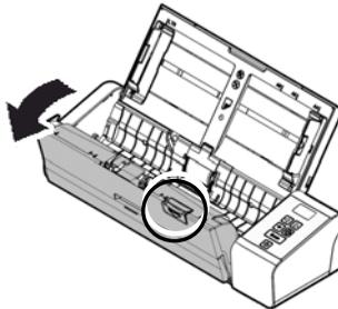
3. Aperte os dois braços do suporte de separação para dentro com os dedos (①) e levante-os (②) para remover o suporte de separação.
