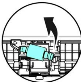
6. Anexe os rolos de alimentação novos. Insira a extremidade esquerda do eixo no encaixe e deslize o rolo de alimentação para a direita. Um som de encaixe pode ser ouvido.
