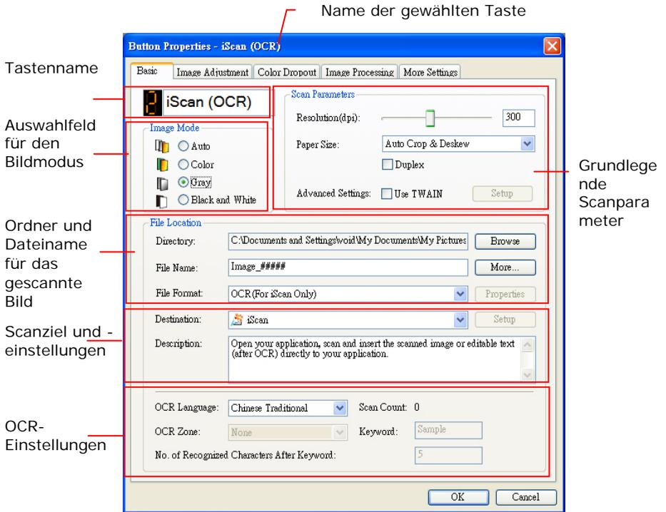
Hier können das Dateiformat, die Ziellanwendung und andere Scaneinstellungen geändert werden.
