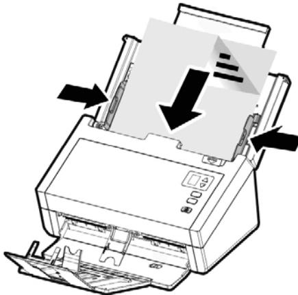
5. Richten Sie die Vorlage an den Führungsschienen aus.
