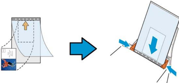
**2. Legen Sie das Trägerblatt mit dem grauen Bereich (bedruckter Bereich) nach unten ein.**
