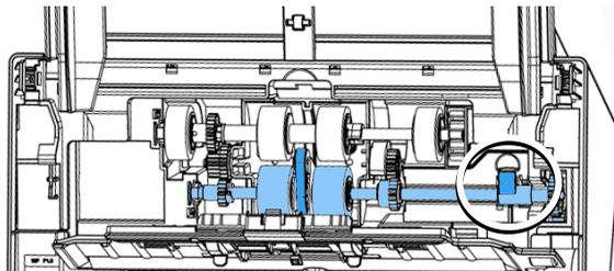
3. Feche a tampa do Rolamento ADF. Um som de encaixe poderá ser ouvido se for instalado corretamente.
