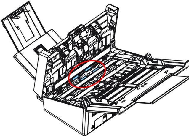
5. Una volta terminata la pulizia, premere il tasto [Scansione]
