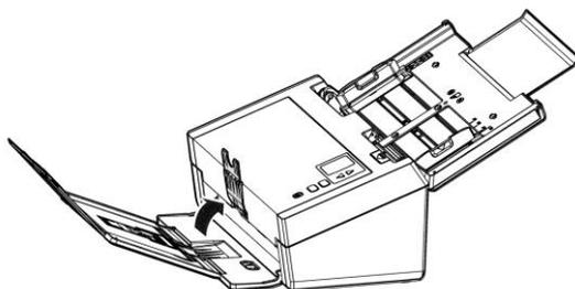
2. Far scorrere il regolatore della posizione del vassoio di uscita in modo da mettere il vassoio in posizione pari.
