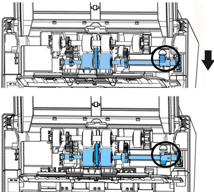
4. Снимите правый конец нижней ролика автоподатчика из гнезда и снимите ролика автоподатчика.
