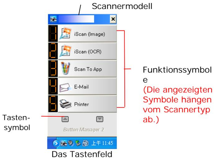
3. Im Tastenfeld werden die ersten fünf Scantasten angezeigt. Klicken Sie mit der rechten Maustaste auf die Taste (Funktion), die Sie prüfen möchten. Das Fenster "Tasteneigenschaften" wird angezeigt.
