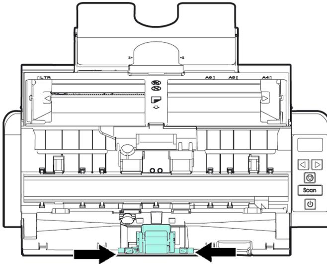
4. Drücken Sie die zwei Hebel des neuen Trennpolsters wieder mit zwei Fingern zusammen, und setzen Sie es so in die entsprechende Position ein.
