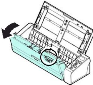
3. Drücken Sie die zwei Hebel des Trennpolsters mit zwei Fingern (①) zusammen, und ziehen Sie es heraus (②).
