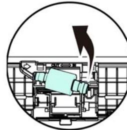
6. Bringen Sie die neuen Einzugschwaben an. Stecken Sie das linke Ende des Schafts in die Kerbe und schieben Sie die Einzugschwabe nach rechts. Sie sollte hörbar einrasten.
