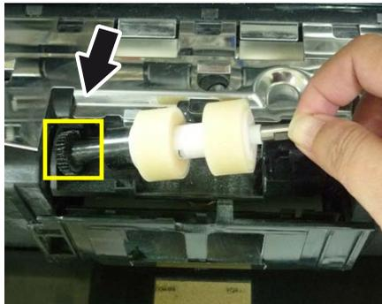
7. 将反转轮右端插入插槽，如果插入正确，可以听到轻脆的卡入声。
