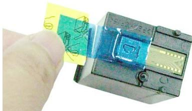
5. 握住墨水盒的拉柄，请勿触摸墨水喷嘴 (①) 或铜色接点 (②)。请勿更换接点上的保护胶带。处理这些部位可能会导致喷嘴堵塞、无法喷墨和电子接点接触不良。
