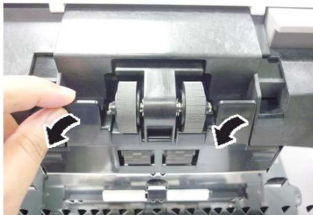
3. 将卡榫往下扳，即可将自动输稿器滚轮组件取出。
