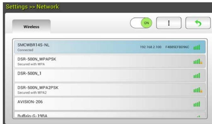
5. Sélectionnez un point d'accès et cliquez sur [**Connect (Connecter)**] pour connecter le scanner à un point d'accès spécifié, par exemple SMCWBR14S-NL. En quelques secondes, si la connexion est réussie, l'adresse IP et l'adresse Mac du scanner sont affichées comme indiqué ci-dessus.
