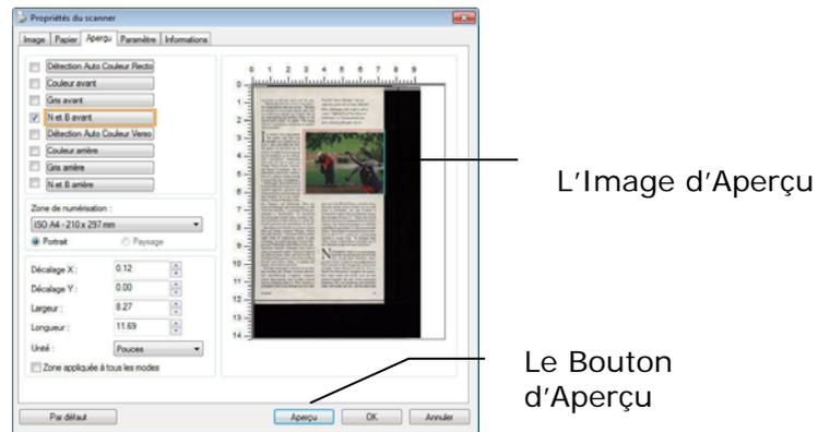
5. Sélectionnez le type d'image à partir de la boîte Sélection d'Image. L'image sélectionnée apparaît en surbrillance. (Par exemple, Couleur Avant)
