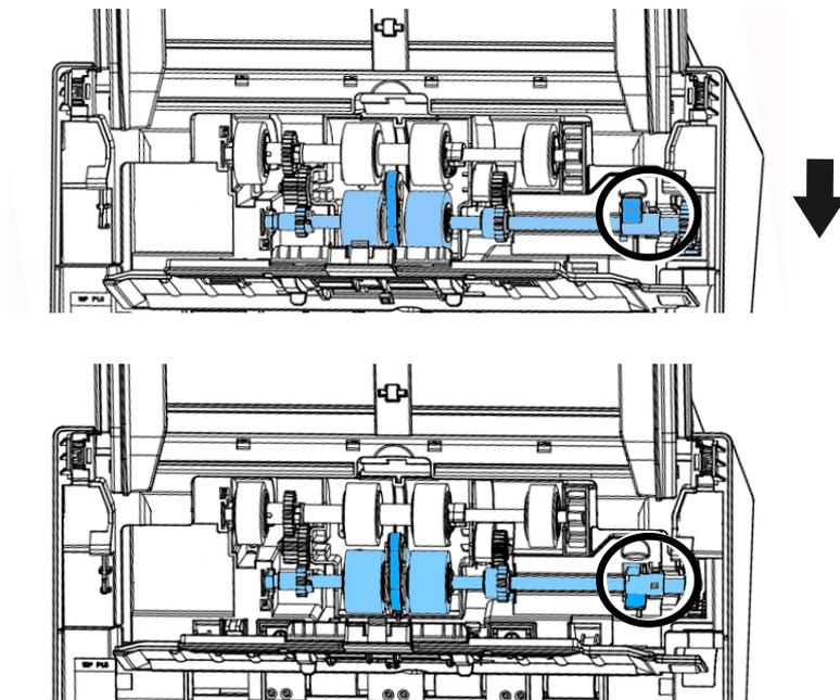
4. Détachez l'extrémité droite du rouleau ADF de la fente et retirez le rouleau ADF inférieur.
