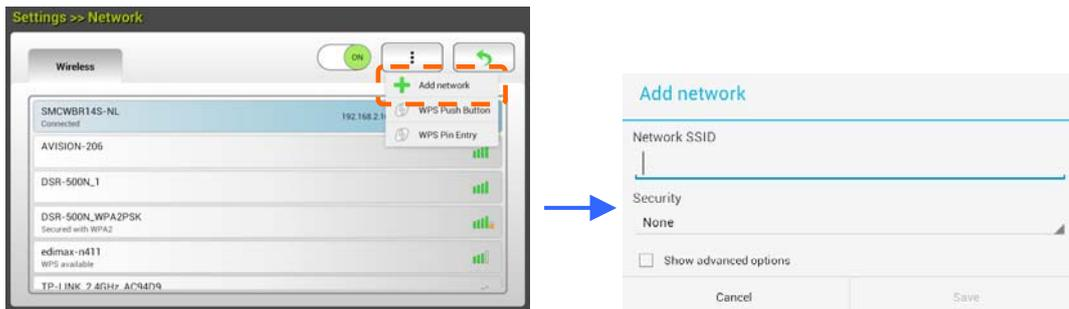
2. Entrez le nom SSID du réseau et choisissez le mode de sécurité, le type de chiffrement, et la clé réseau, puis appuyez sur [**Save (Enregistrer)**] pour rechercher le réseau sans fil manuellement.
