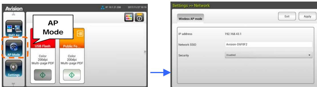
4. Sur vos appareils mobiles, assurez-vous que Avision-xxxxxx (xxxxxx indique les six derniers chiffres de l'adresse Mac figurant à l'arrière du scanner) a été sélectionné comme nom de réseau (SSID).
