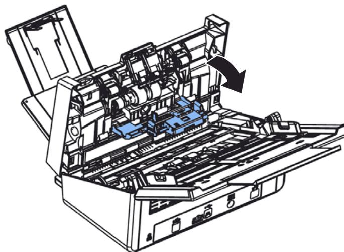
4. Appuyez sur l'extrémité droite du rouleau inverse à l'extérieur pour le détacher de l'emplacement, puis retirez l'extrémité gauche de son trou.
