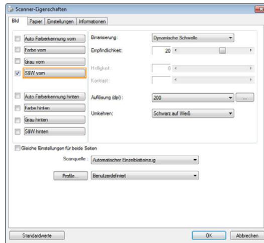
6. Wählen Sie aus dem Bildauswahlfeld den für das gescannte Bild gewünschten Bildtyp aus. (Die Standardeinstellung ist S/W). Wenn Sie einen Duplex-Scanner haben, wählen Sie Front (Vorderseite) und Rear (Rückseite), um beide Seiten des Dokuments zu scannen.
