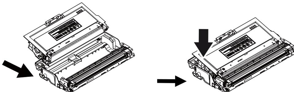
7. Halten Sie den Griff des Einbauteils mitsamt Trommeleinheit und Tonerkartusche fest und setzen Sie die Kartusche wieder an ihrer ursprünglichen Stelle ein.
