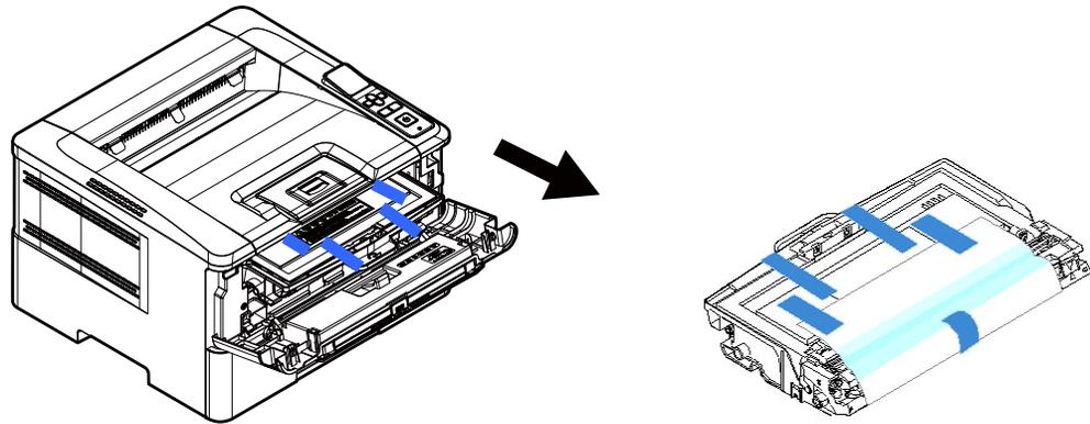
3. Entfernen Sie die Schutzbänder und das Etikett von der Trommeleinheit.
