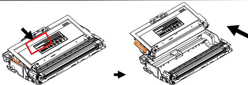
5. Ziehen Sie die Schutzfolie der Tonerkartusche heraus, bis sie vollständig entfernt ist.
