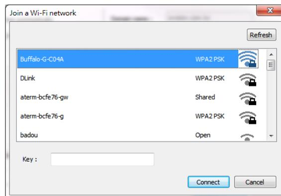
7. Klicken Sie auf **„Connect (Verbinden)“**, um sich mit der SSID (WLAN-Name) zu verbinden, und aktualisieren Sie dann die IP-Informationen des Produkts.
