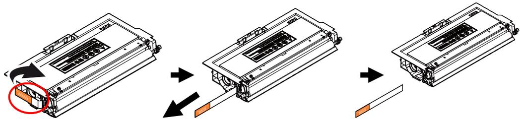
4. Installieren Sie die Tonerkartusche in der Trommeleinheit.
