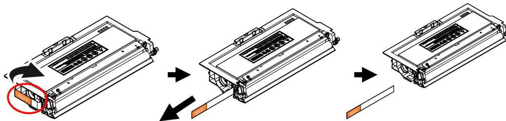
6. Installieren Sie die Tonerkartusche in der Trommeleinheit.
