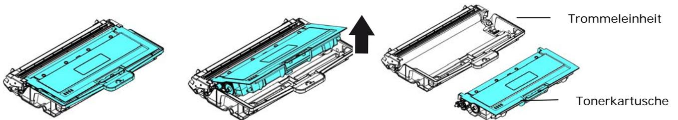
5. Reinigen Sie die Trommeleinheit mit einem sauberen und weichen Tuch.
