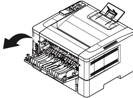
Duplexeinzug: Ziehen Sie den Duplexeinzug unterhalb der rückseitigen Abdeckung aus der Maschine heraus.
