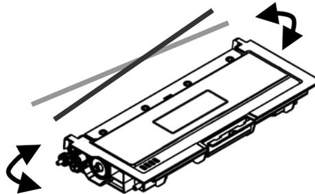
3. Ziehen Sie die Schutzfolie der Tonerkartusche heraus, bis sie vollständig entfernt ist.
