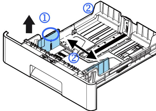
5. Heben Sie die Mitte der Längsführung (③) und schieben Sie die Führung (④) in die richtige Position für das Papier, das eingelegt werden soll.
