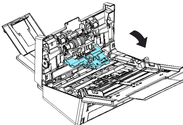
4. Нажмите на правый край реверсивного ролика по направлению вовнутрь, извлеките его из слота, а затем извлеките левый край из соответствующего отверстия.
