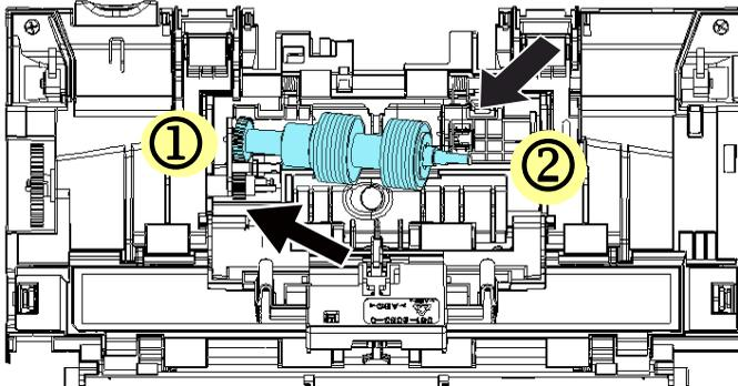
5. Закройте крышку реверсивного ролика.
