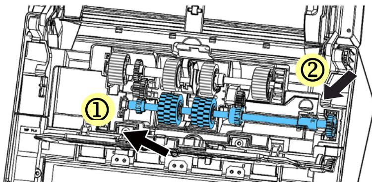
2. Передвиньте язычок на нижнем ADF ролике, как указано на рисунке.
