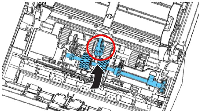
4. Передвиньте язычок на нижнем ADF ролике, как указано на рисунке.
