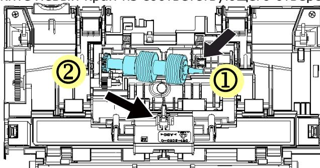
5. Снимите ролики с вала.
